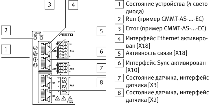
Fig. 12 Светодиоды на передней стороне (пример CMMT-AS-...-EC)
