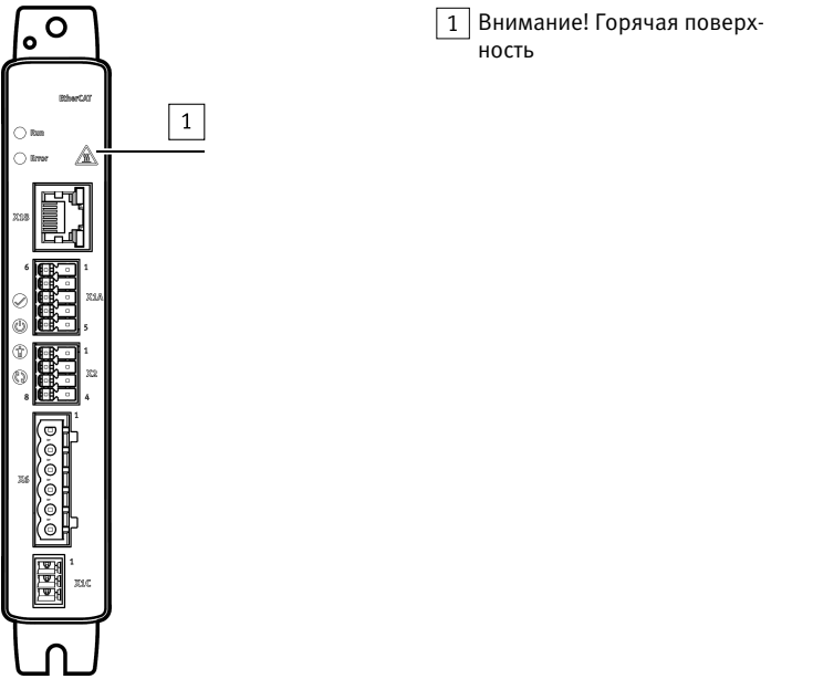
Fig. 1 Предупредительный знак на передней стороне изделия (пример CMMT-ST-...-EC)
