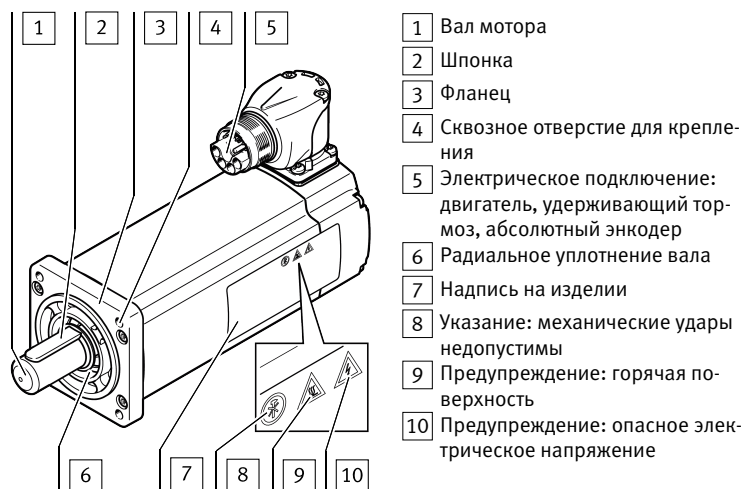
Fig. 1 Конструкция EMMT-AS (на примере AS-60-L-KR-LS-RMB)
